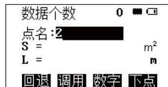
④输入点名后按F4下点键，显示下一个点号，重复按F4（下点）键，设置所需要的点号，当设置3个点以上时，这些点所包围的面积就被计算，结果显示在屏幕上。
