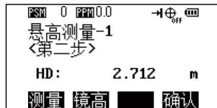
②以输入镜高为例，按F1输入镜高键，输入棱镜高度。
