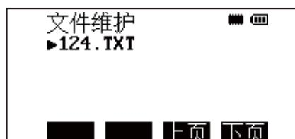
4. 选择要导入的文件点ENT确定，选择坐标格式后自动导入数据到全站仪
